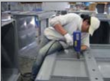
Aneinander geschweißte Palettenboxen. Auch die Deckel wurden im Spiegelschweißverfahren zusammengefügt (abgebildete Maße, inkl. Deckel: 1680 x 1000 x 820 mm und 2180 x 1000 x 820 mm).
