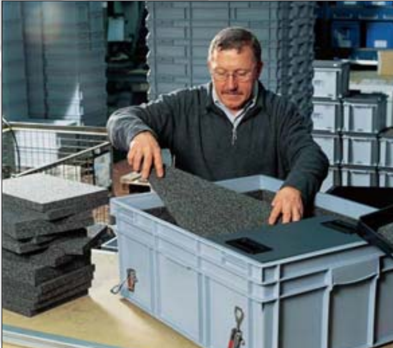
Umbau eines Standardbehälters in eine kundenspezifische Mehrweg-Transportverpackung
