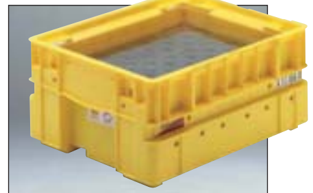
Dieser VDA-Transportbehälter schützt den Inhalt aus unbehandeltem Stahl wirkungsvoll vor Korrosion. Dies wird durch das Ausschwitzen von einigen Milligramm ECM erreicht. Voraussetzung ist, dass der Behälter mit einem Deckel (hier aus transparentem PET) versehen ist.
