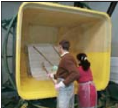
Produktion eines Polyesterbehälters (Einbringen der Glasfasermatten).
