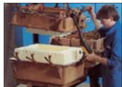
Nach dem Abkühlen wird das fertige Produkt aus der Form genommen.
