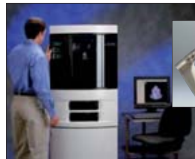
Häufig entscheidet man sich dafür, ein Modell in Originalgröße herzustellen – ein kostenintensives Unterfangen. Mit modernsten CAD-Programmen lassen sich sog. Rapid Prototyping Machines steuern, die ein Muster in nur wenigen Stunden entstehen lassen.
