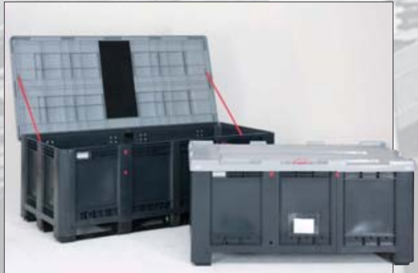
Aneinander geschweißte Palettenboxen. Auch die Deckel wurden im Spiegelschweißverfahren zusammengefügt (abgebildete Maße, inkl. Deckel: 1680 x 1000 x 820 mm und 2180 x 1000 x 820 mm).
