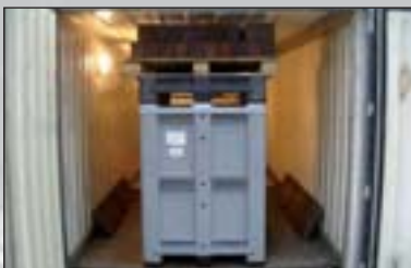
Eine ganze Reihe von Prüfungen muss bestanden werden bevor ein Behälter das ADR-Prüfsiegel erhält, z.B. ein Dauertest des Stapels bei 40 °C.
