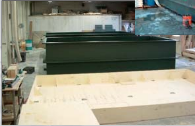
Polyesterbehälter können in nahezu jeder Größe hergestellt werden. Hier stehen Behälter aus Polyester mit einem Holzkern. Anwendungsbereiche: u.a. Wasseraufbereitung, Fischzucht, Galvanisieren.
