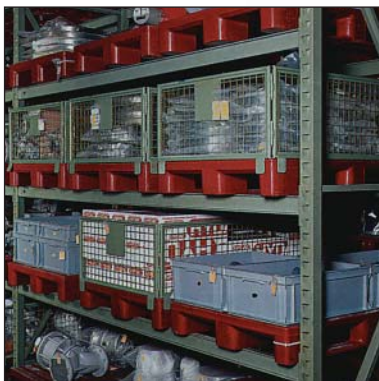
Industriehygienepaletten sind auf 3 Kufen und mit einer umlaufenden Palettenkufe lieferbar. Um die Belastbarkeit zu erhöhen ist eine Verstärkung der Innenseite mit Stahlrohren optional möglich.
