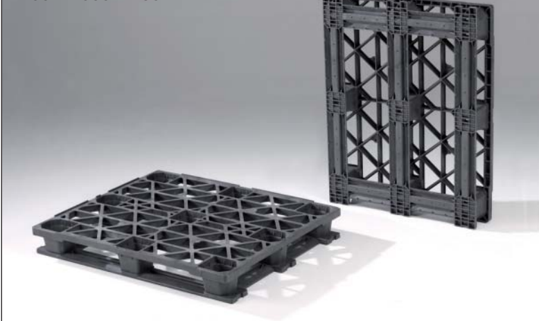
Besonders robuste Exportpaletten mit 3 Kufen und umlaufenden Unterrahmen. Sie werden serienmäßig aus PO hergestellt (Ausführung in HDPE auf Anfrage möglich).
