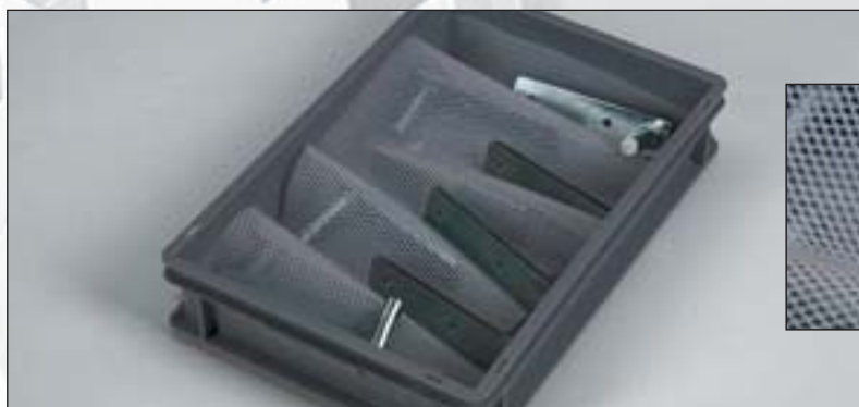
Kunststoffnetze schützen den Inhalt vor Kratzern und Beulen.
