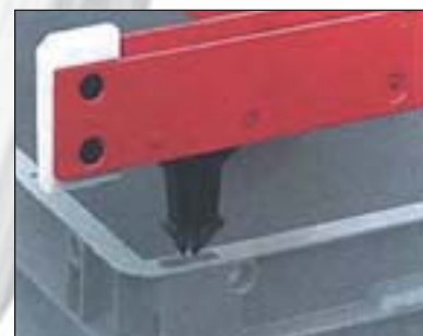
Aufnahmepunkte für Palettierroboter.
