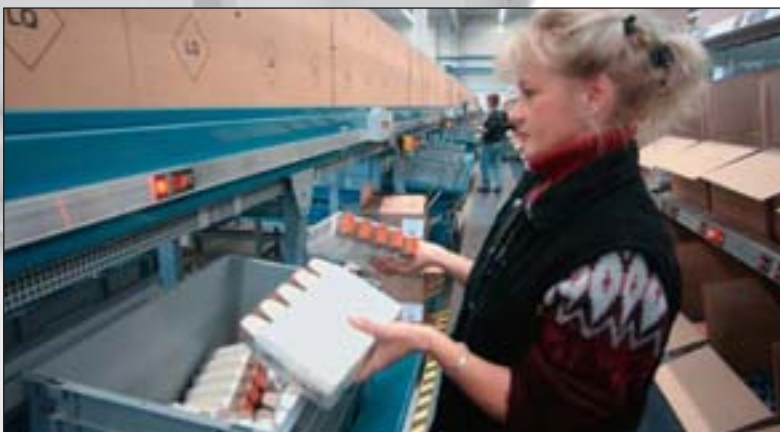
Eurotec-Behälter in einem Pick-to-Light Lager. (Foto: Vanderlande Industries, NL)
