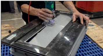
Der Boden des Behälters wird mit einer Schablone ausgefräst.
