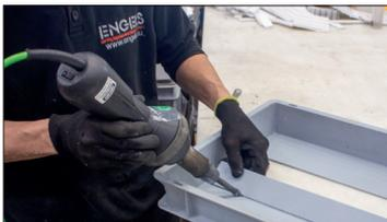
Danach werden die Schrägen für die Grillen in den Behälter eingepasst und angeschweißt.
