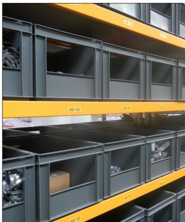
**E-Line-Regalkästen mit Öffnungen an der kurzen Seite, hier in Kombination mit einem Lagerregal. Übersichtliche Lagerung von Bauteilen in einem robusten Behälter mit großem Inhalt.**
